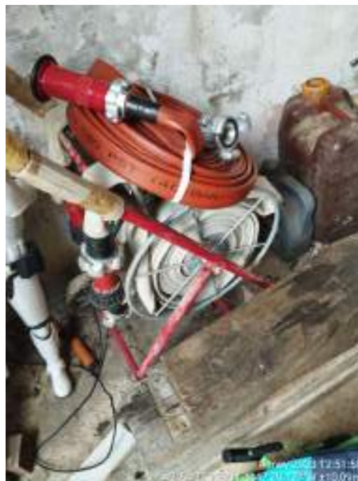
Figura 17: Parte del material comprado por el pueblo de Gulina, se pueden observar mangueras de alta presión de 25mm de diametro con sus reducciones y punta de lanza junto a carretes de manguera semirigida.
